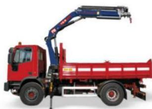
L'autocarro con gru è una macchina utilizzata per il trasporto di mezzi, materiali da costruzione e/o di risulta da demolizioni o scavi, ecc., il braccio elevatore telescopico installato nel mezzo per il sollevamento e movimentazione dei carichi comporta l'utilizzo di stabilizzatori.
